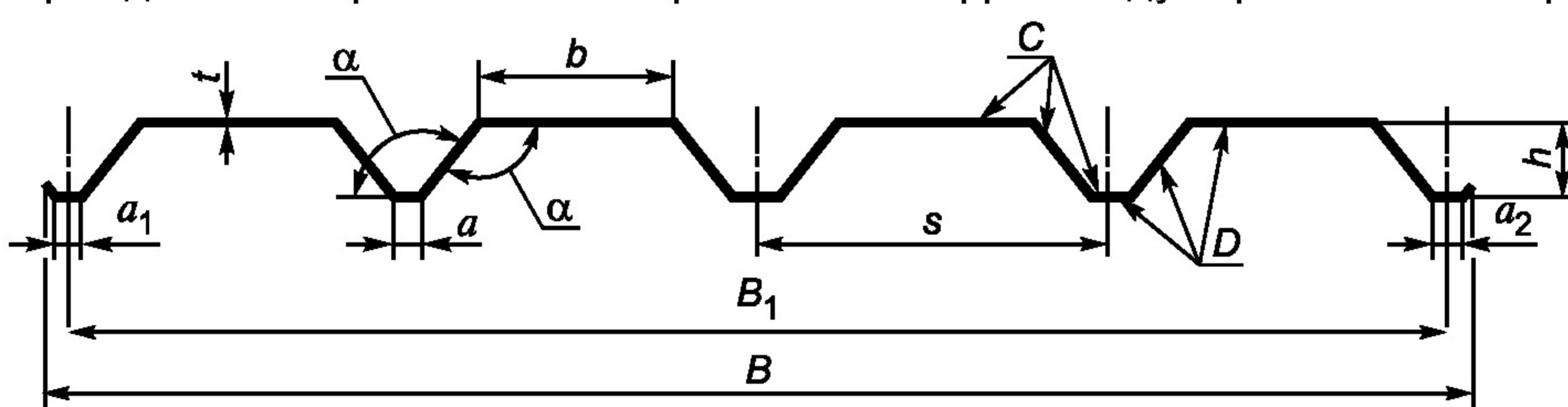
$B_1$  — монтажная ширина профиля;  $B$  — общая ширина;  $h$  — высота профиля;  $t$  — толщина профиля;  $s$  — шаг гофров;
