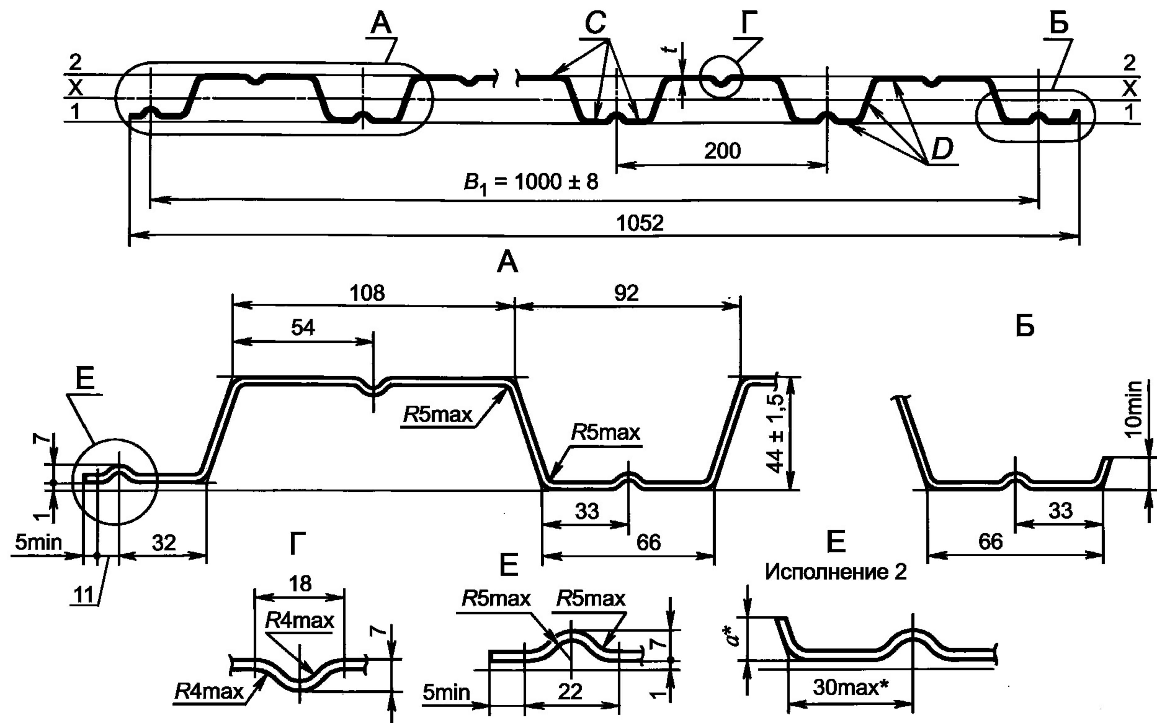
Рисунок Б.7 — Профили типа НС высотой 44 мм
